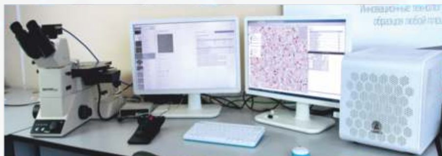
Пост микроконтроля МК-1 на базе микроскопа МИ-1 с ПО SIAMS 800
